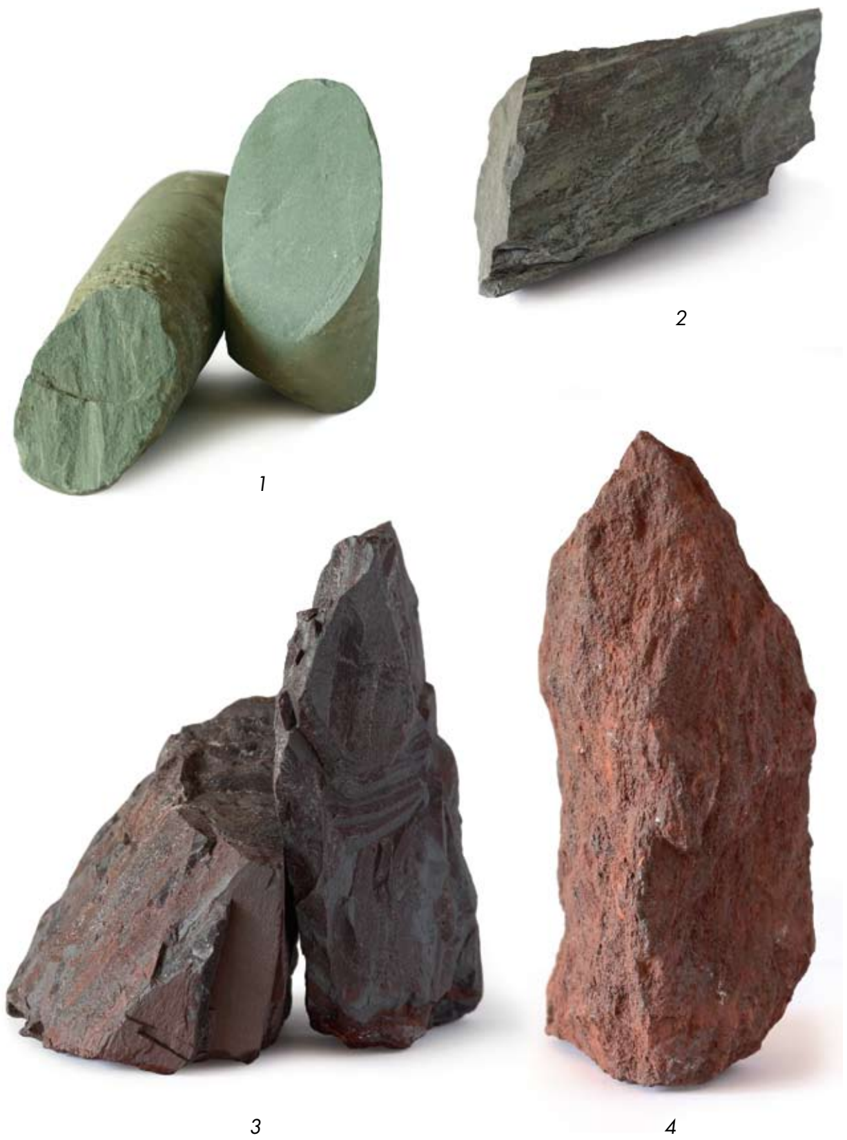
Рис. 1. 1 – зеленый сланец; 2 – сланец кварц-серицит-магнетит-хлоритовый гл. 940 м; 3 – кварцит гематит-мартитовый; 4 – руда гематит-мартитовая
